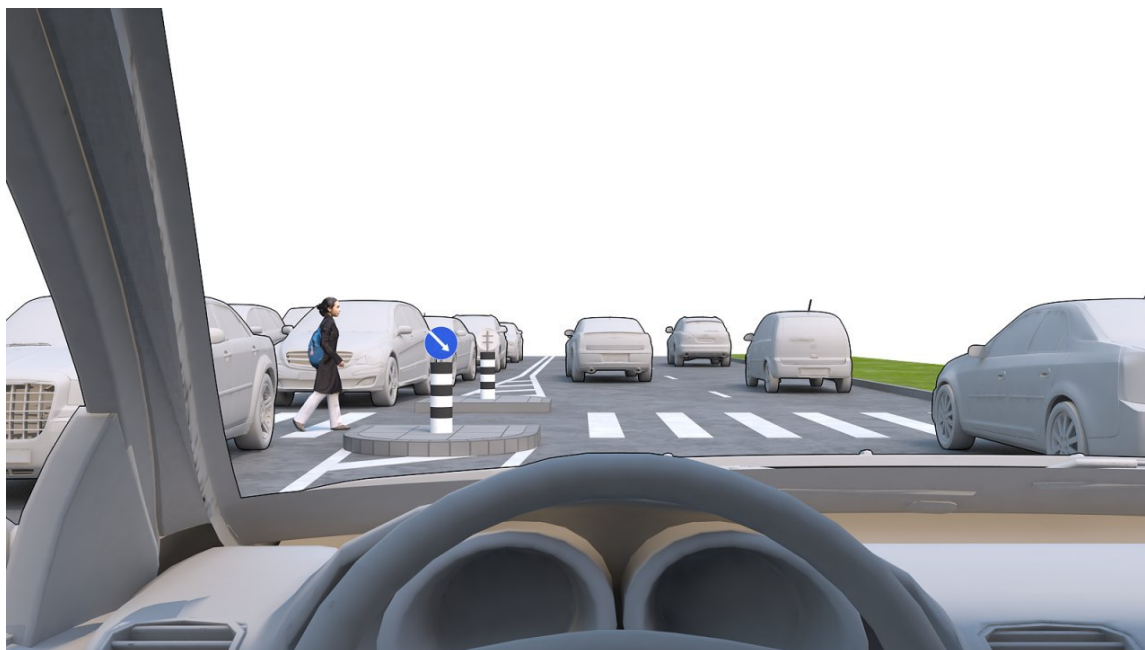
Рисунок 6 – Приподнятый островок безопасности позволяет раньше заметить переходящего проезжую часть пешехода и дает водителям транспортных средств больше времени для предотвращения наезда.
