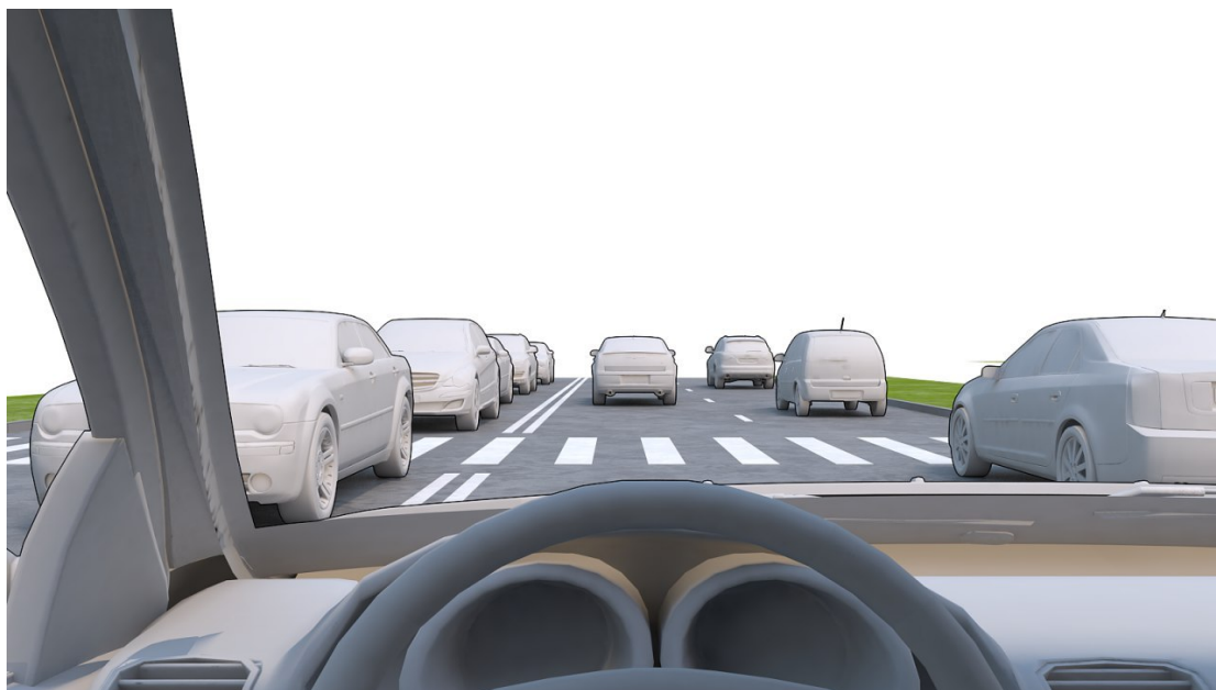
Рисунок 5 – Переходящего проезжую часть по нерегулируемому пешеходному переходу пешехода не видно за встречным потоком транспорта.
